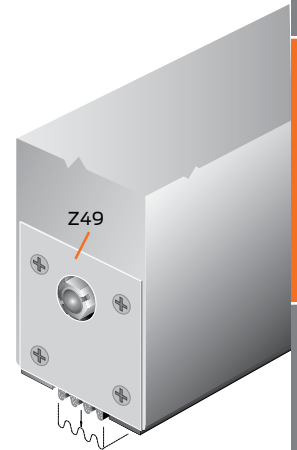
Concealed door bottom
